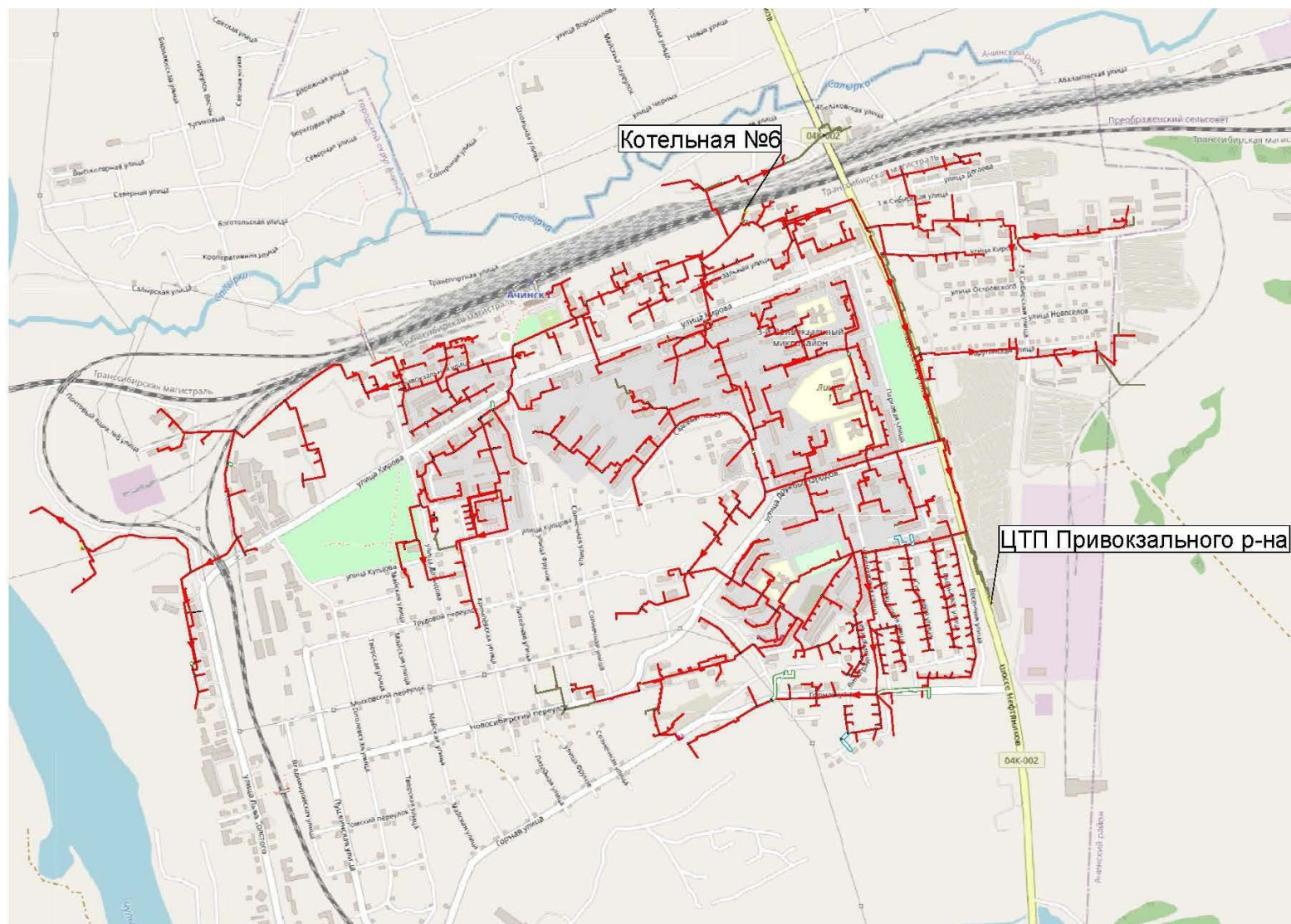
Рисунок 4.2.4. Перспективная схема сетей котельной №6 ООО «Теплосеть»
