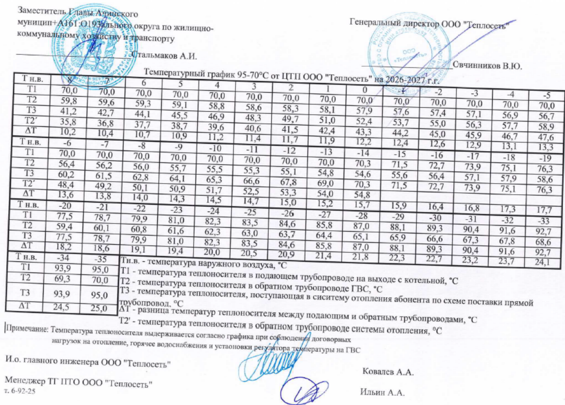
Рисунок 1.3.6.2 - График регулирования температуры сетевой воды от котельной № 1
