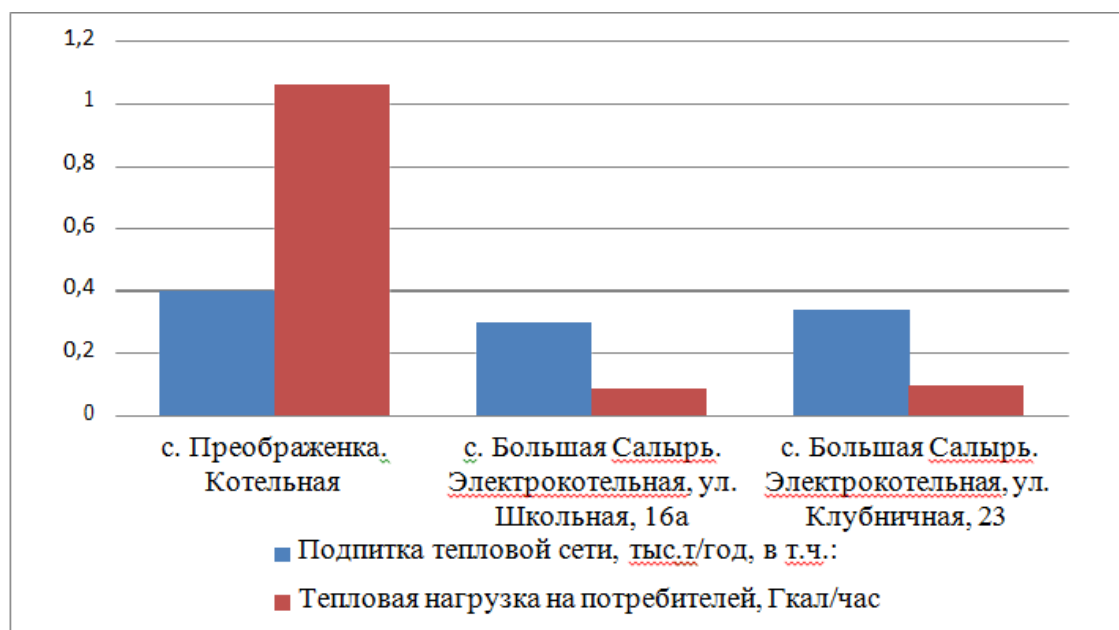
Рисунок 5. Зависимость объема подпиточной воды от расчетной тепловой нагрузки источника тепла.
