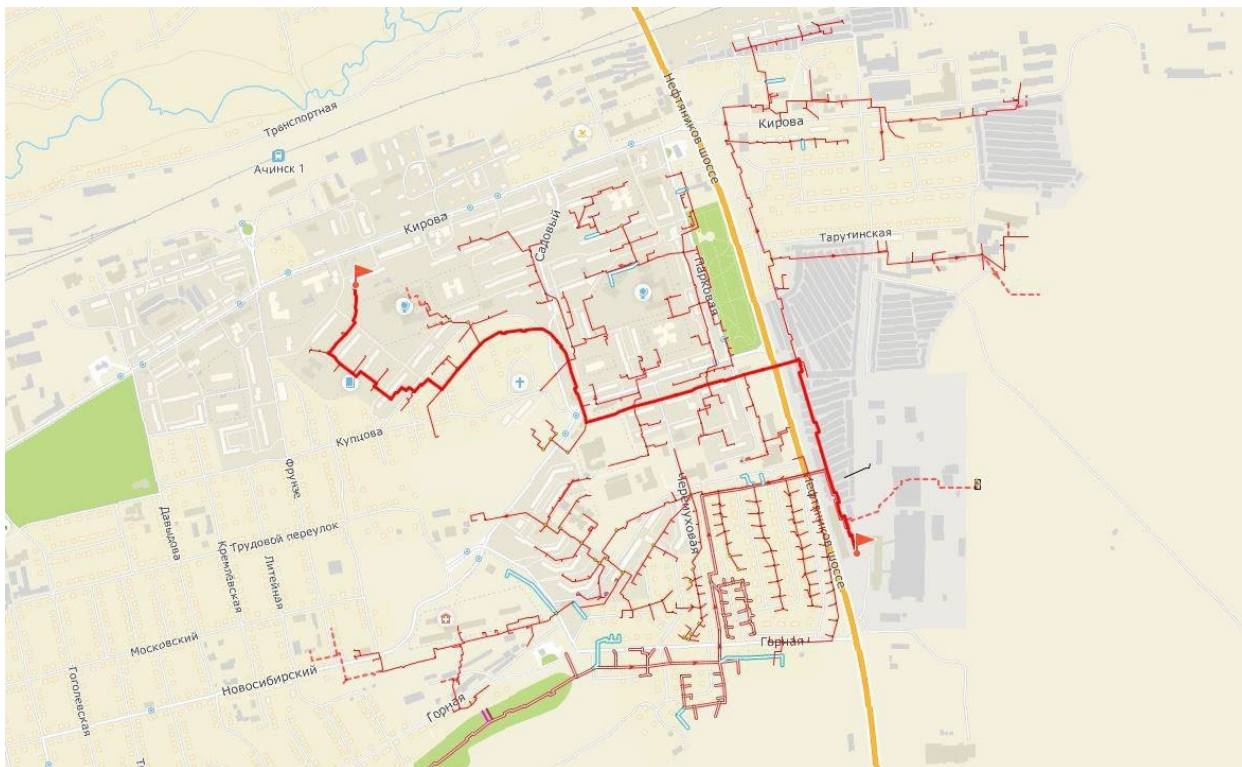
Рисунок 1.3.8.7 - Путь пьезометрического графика от ЦТП до Кирова, 41
