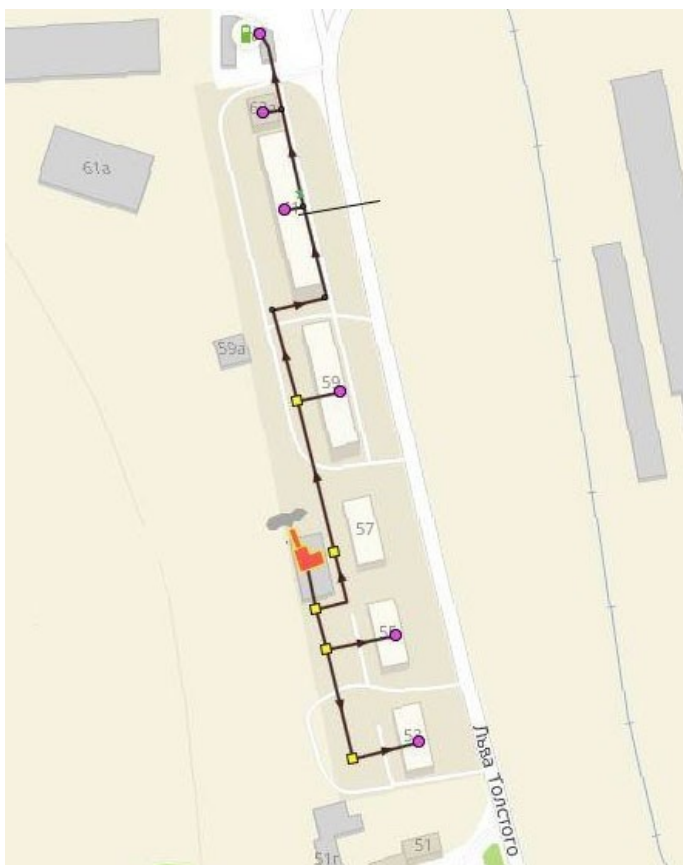
Рисунок 1.3.2.2 - Схема тепловой сети котельной № 1
