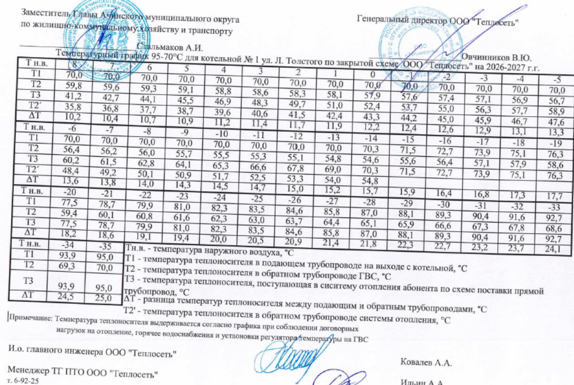
Рисунок 1.3.6.2 - График регулирования температуры сетевой воды от котельной № 1
