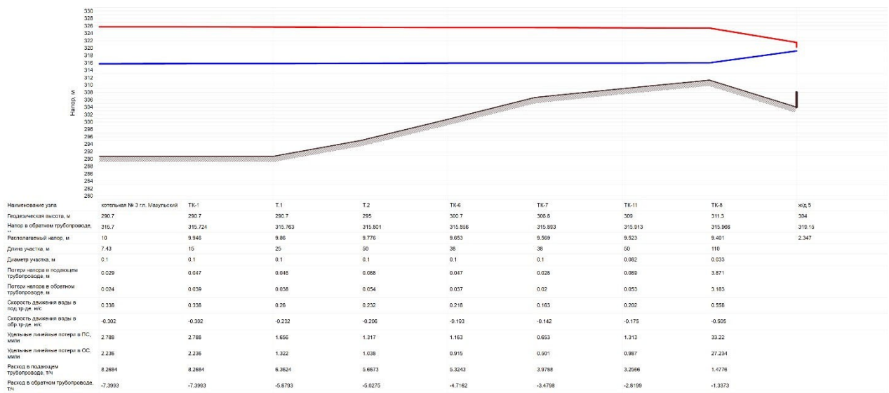
Рисунок 1.3.8.14 - Пьезометрический график от Котельной № 3
