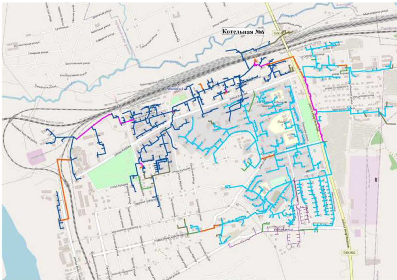
Рисунок 4.1.2. Схема сетей теплоснабжения после переключения части потребителей от ТЭЦ АО «РУСАЛ Ачинск» к котельной № 6 ООО «Теплосеть»
