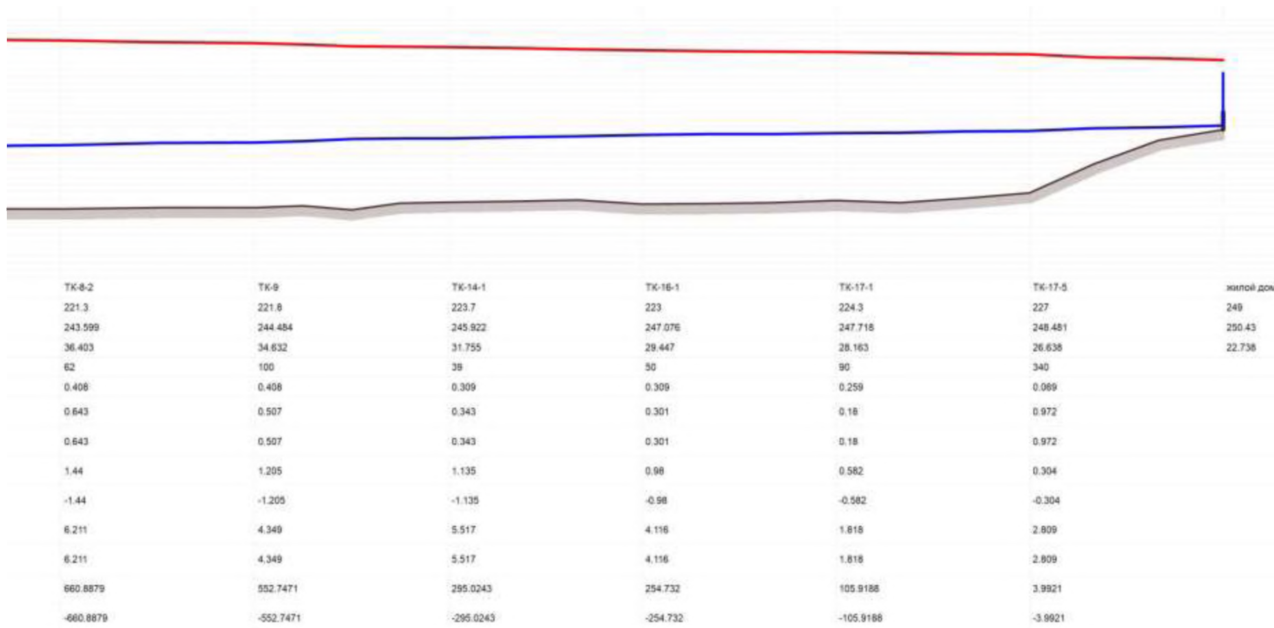
Рисунок 4.2.18. Пьезометрический график котельная № 6 – жилой дом
