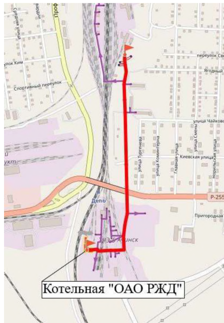
Рисунок 4.2.27. Путь построения пьезометрического графика котельной ОАО «РЖД»
