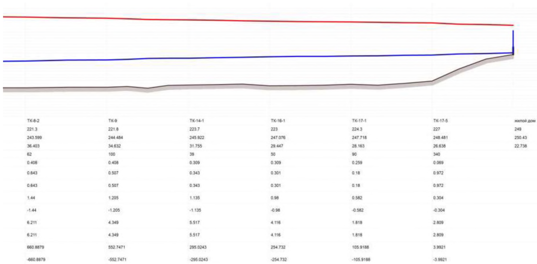
Рисунок 4.2.18. Пьезометрический график котельная №6 – жилой дом
