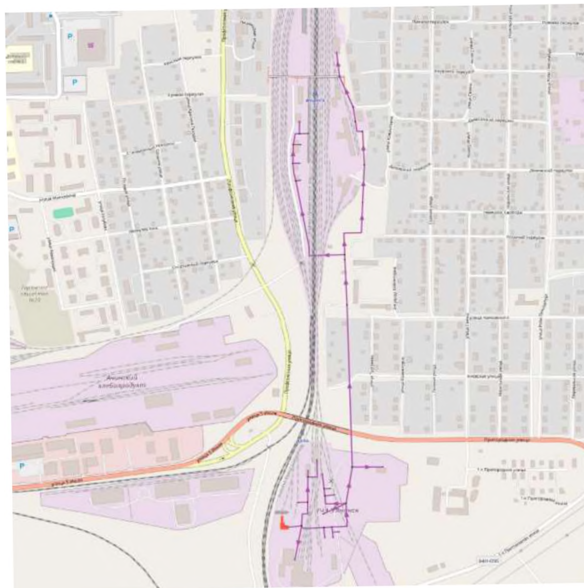
Рисунок 4.2.6. Перспективная схема сетей котельной ОАО «РЖД»
