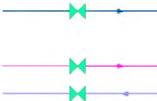
Рисунок 3.2.10 - Однолинейное и внутренне представление задвижки
