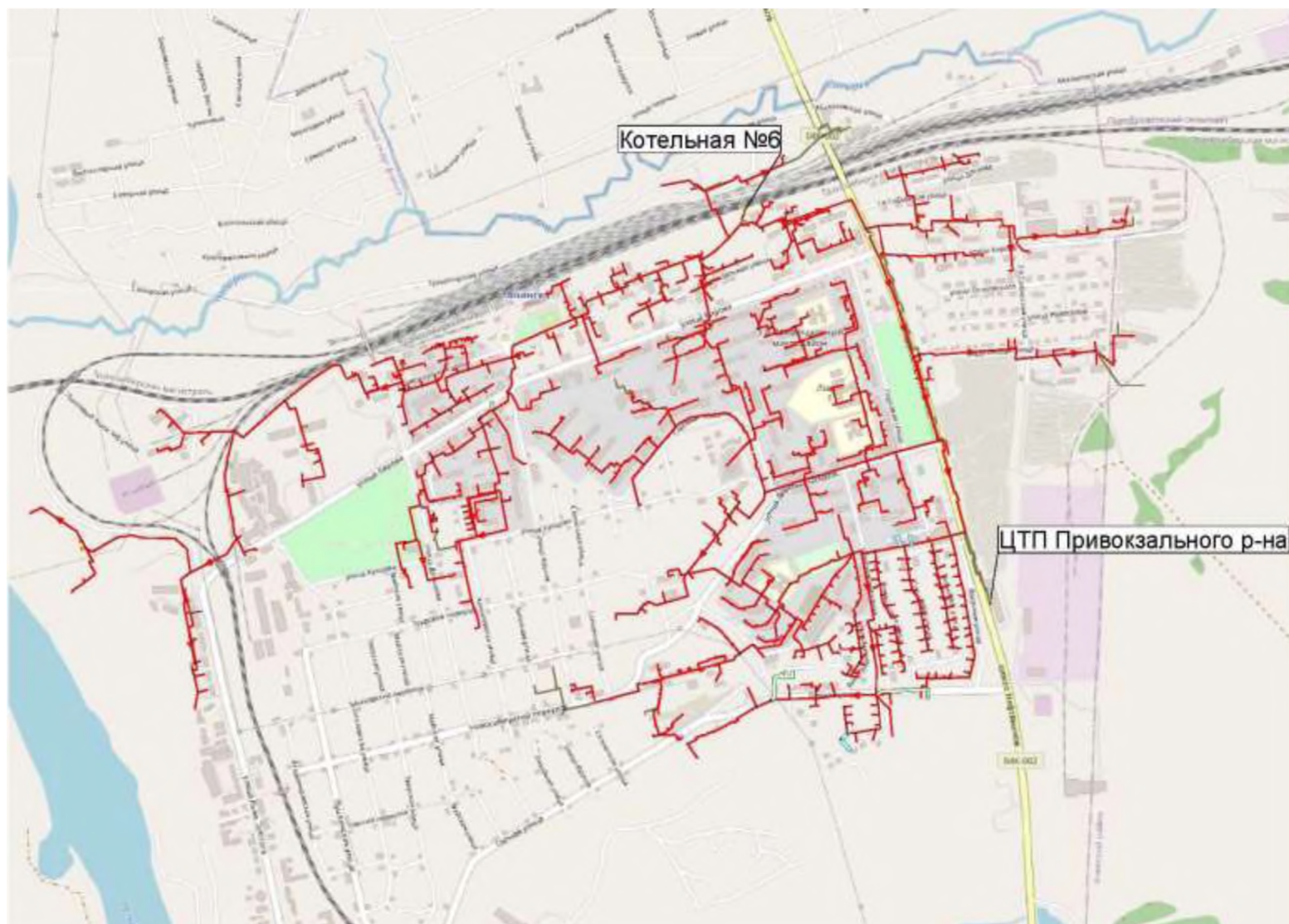
Рисунок 4.2.4. Перспективная схема сетей котельной №6 ООО «Теплосеть»
