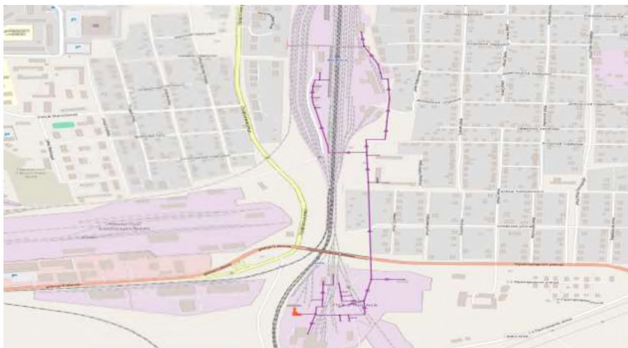
Рисунок 1.3.2.8 - Схема тепловой сети котельной ТК «Восток»
