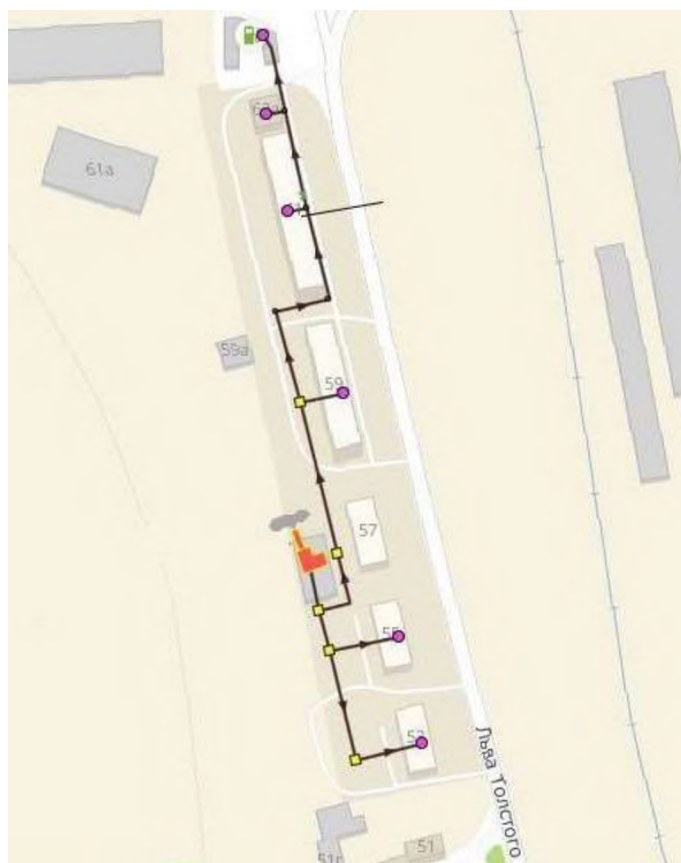
Рисунок 1.3.2.2 - Схема тепловой сети котельной №1
