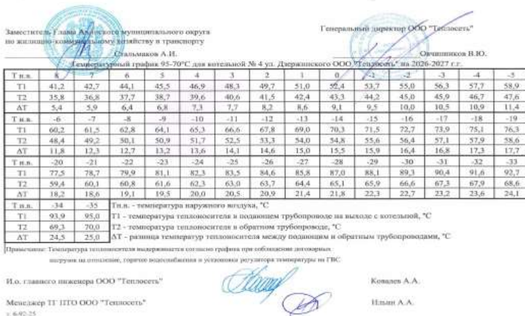
Рисунок 8.5.5 - График регулирования температуры сетевой воды от Котельной № 6
