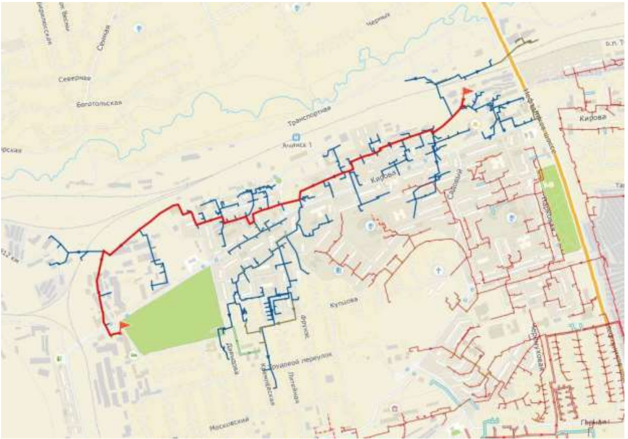
Рисунок 1.3.8.15 - Путь пьезометрического графика от Котельной №6
